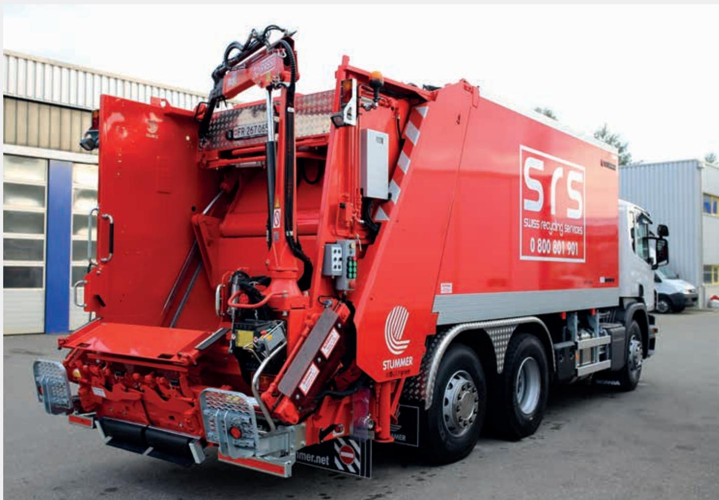
Dieses System ist mit 4 bis 8 Wiegezellen ausgestattet, welche zwischen dem Lastwagenfahrgerüst und dem Aufbau (z. B. Kehricht-Aufbau) angebracht sind. Es misst die zunehmende und in den Aufbau zugeladene Last während der Auffüllphase. Die Messdaten werden für jeden Kunden aufgezeichnet.
