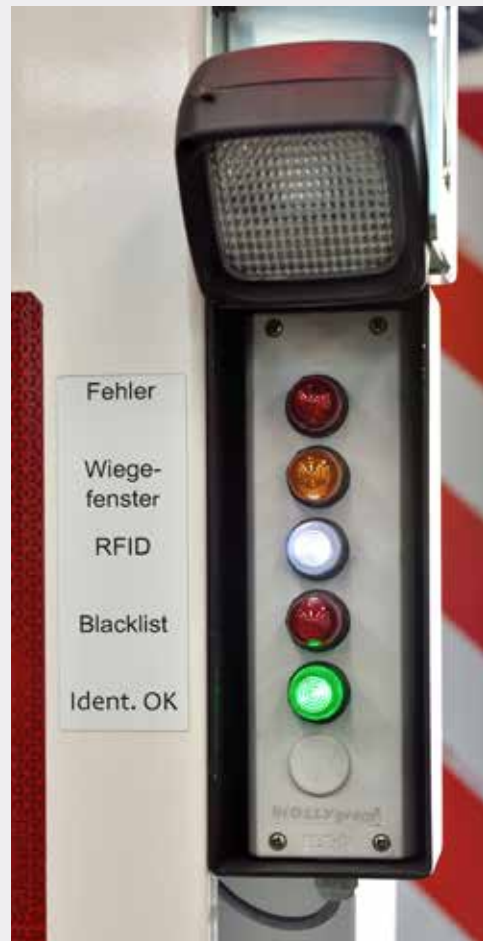
Anhand der Signallampen kann der Belader den Wägezyklus sowie die Steuerung der Chips überwachen
