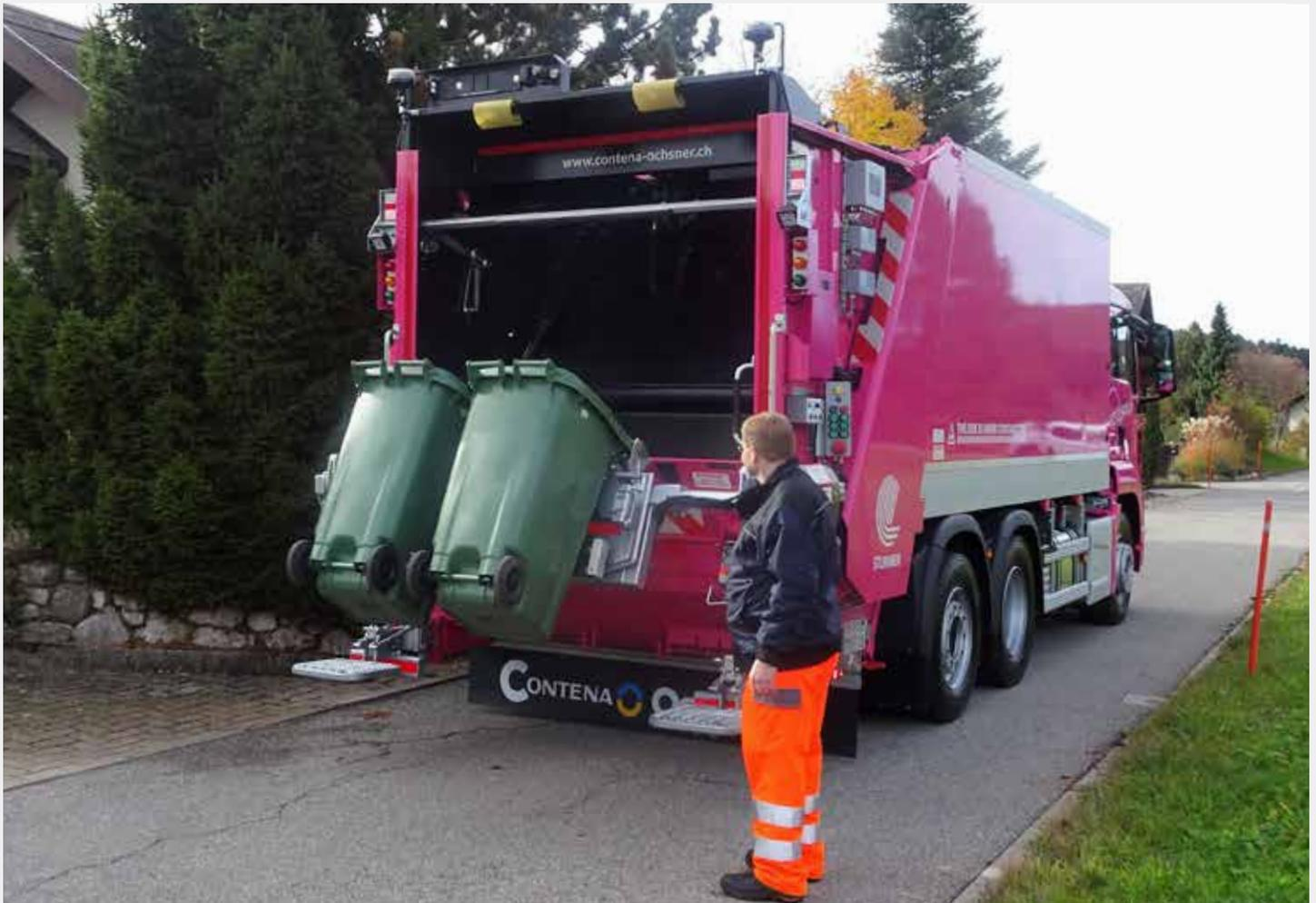
Das Sammelfahrzeug verfügt über einen Doppel-Lifter. Jede Liftereinheit ist mit Wiegezellen ausgestattet, die zwischen dem Arm und der Hebevorrichtung angebracht sind. Die Vorrichtung misst das Gewicht des Behälters ein erstes Mal während der Hebephase und ein zweites Mal während der Senkphase und dies, ohne anzuhalten. Der Unterschied zwischen den zwei Gewichten ergibt den Messwert. Die Daten werden für jeden Kunden gespeichert.
