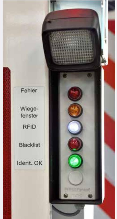
Anhand der Signallampen kann der Belader den Wägezyklus sowie die Steuerung der Chips überwachen
